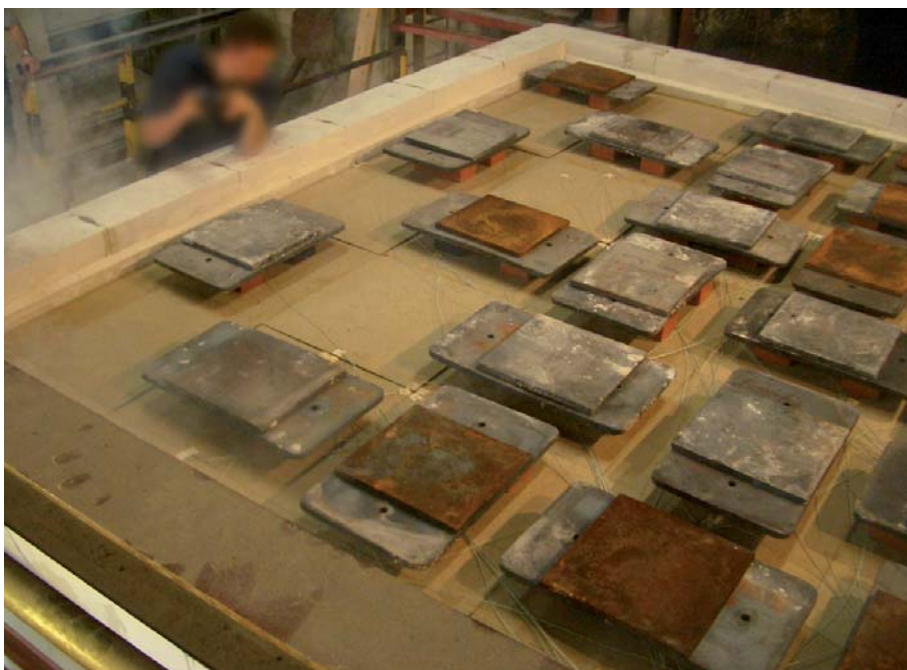
Испытание фальшпола на огнестойкость при нагрузке по DIN 4102/2.
